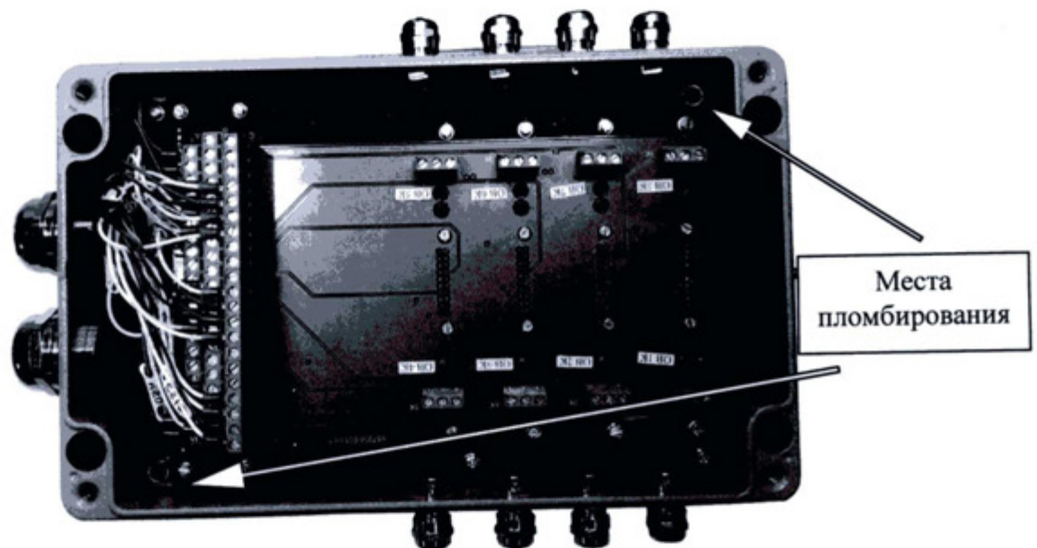
Рисунок 2 - Схема пломбирования блока согласующего БС-16-11М
