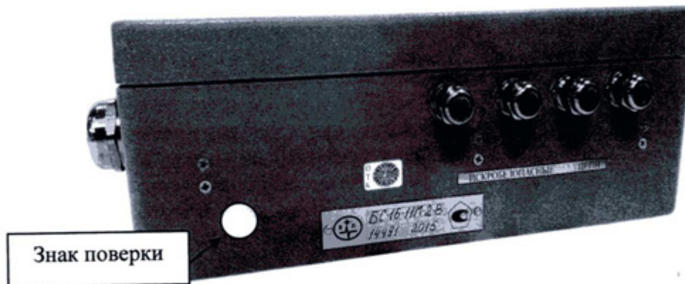
Рисунок 1 – Общий вид блока согласующего БС-16-11М, обозначение места для нанесения знака поверки
