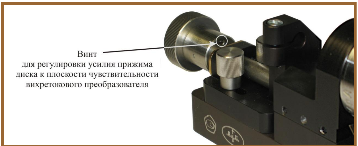
Рисунок 7Б – Регулировка усилия прижима.
