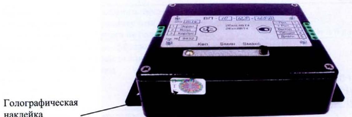
Рисунок 2. Схема пломбировки от несанкционированного доступа, обозначения мест для нанесения оттисков клейм и нанесения наклеек
